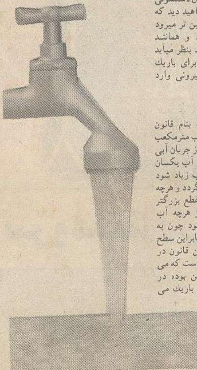
هنگامیکه شیرآب را باز می‌کنند و آب جریان یافته به پائین میریزد، اگر به آبی که لوله شده از شیرآب بدورون دستشویی میریزد خوب نگاه کنید خواهد دید که این آب لوله شده هرچه پائین تر میرود قطر لوله اش کمتر می‌شود و همانند مخروطی معکوس ولی بلند بنظر می‌اید آیا علت آرا میدانید؟ آیا برای باریک شدن آب از خارج بدان نیرویی وارد می‌گردد؟
